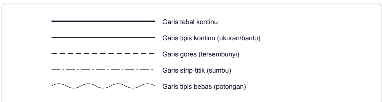
Gambar 2.3 — Macam-macam garis pada gambar teknik
